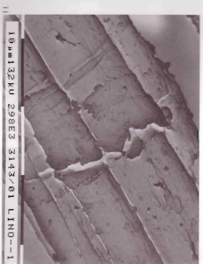
Fig. 10 - Fibra di lino accentratamente degradata con evidente frattura longitudinale (SEM).
