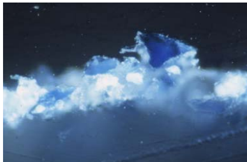
Figura 12. L’analisi mostra la presenza di smaltino con carbonato basico di piombo, il legante è di natura proteica
