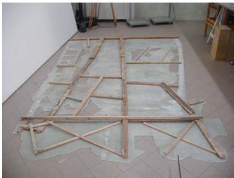
Figure 21 e 22 . dima della struttura lignea sul vetroresina
