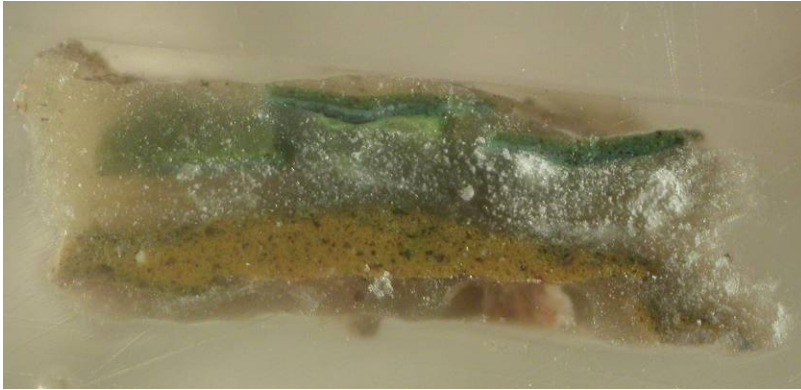
Figura 3. Stratigrafia. Presenza di cera tra gli strati.
